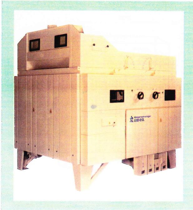
Die PETKUS-Universalreiniger U 80-12G und U 80-16G sind kompakte Siebsichter mit 3 Siebebenen und 2 Sichtern, die als Vorreiniger, Intensivreiniger und Saatgutreiniger für Getreide eingesetzt werden können. Innerhalb einer technologischen Lösung sind sie nacheinander wahlweise für alle Reinigungsstufen geeignet.
