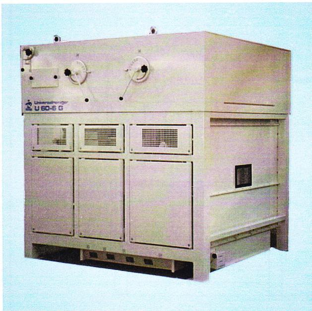
Der PETKUS-Universalreiniger ist ein kompakter Siebsichter mit 3 Siebebenen und 2 Sichern, der als Vorreiniger, Intensivreiniger und Saatgutreiniger für Getreide eingesetzt werden kann.
